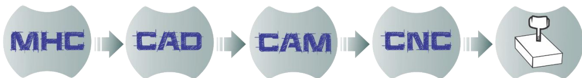
Figura 1.1 Diagrama de flujo de mecanizado en un CNC
